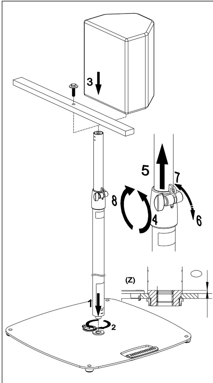
2.) Distanzrohr auf Basis montieren.
