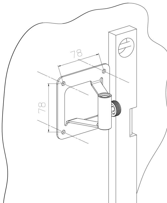
Es müssen alle vier Bohrungen des Wandhalters für die Befestigung genutzt werden. Ein geeignetes Befestigungsmittel muss nach der Wandbeschaffenheit ausgewählt werden.
