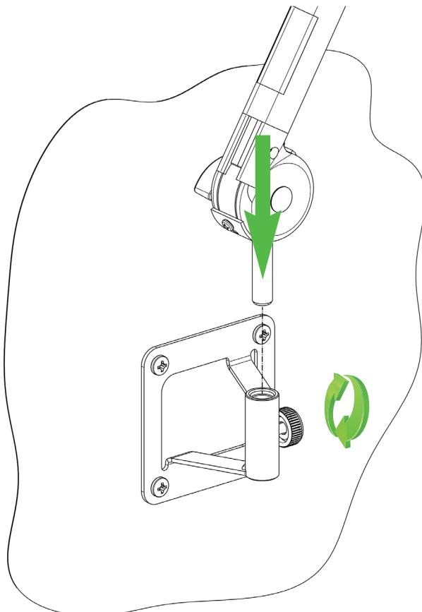
Klemmschraube am Wandhalter lösen. Den Mikrofonarm von oben in den Wandhalter stecken, die gewünschte Position einstellen und die Klemmschraube handfest anziehen.
