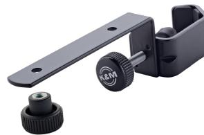
Universeller Haltewinkel mit Klemmprisma passend für alle Rohre mit einem  $\varnothing$  von 7 bis 30 mm. Zwei Bohrungen mit  $\varnothing$  5,2 mm ermöglichen die individuelle Montage von verschiedenen Instrumentenkegeln, Ablageblechen oder anderem Zubehör.
