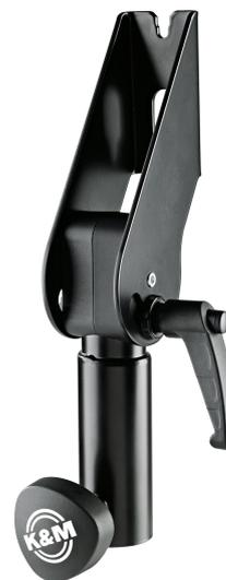
Multifunktionaler Stativadapter zum Aufsetzen auf Stative mit ø 35 mm Auszugsrohren. Der Adapter kann in der Neigung von +60° bis -30° eingestellt werden. Die Fixierung erfolgt über einen verstellbaren Klemmhebel. Mit den Adapterplatten 19615, 19616 und 19617 können die unterschiedlichsten Bildschirme bis zu einem Befestigungslochbild von VESA 200 x 200 mm montiert werden. Die Adapterplatten 24352 bis 24359 sind geeignet, um eine Vielzahl von Lautsprecherboxen aufzunehmen.
