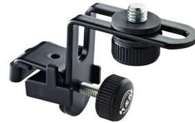
Zur Befestigung von Mikrofonen an Schlaginstrumenten, klein und kompakt. Einfach und schnell zu montieren und demontieren. Schwingungsdämpfung durch Gummischeibe sowie einer Gummieinlage. Die Klemmelemente sind unverlierbar und garantieren einen absolut sicheren Halt. Mit 3/8" Gewinde.
