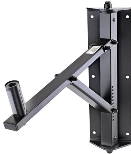
Mit dieser schwenk- und neigbaren Wandhalterung erreichen Sie garantiert die richtige Ausrichtung Ihrer Lautsprecherbox. Die Halterung kann über 11 Stufen bis auf 22° geneigt werden. Der Schwenkbereich ist stufenlos einstellbar. Der patentierte Spreizdorn für Lautsprecher mit Buchseninnen- $\varnothing$  von 35 bis 37 mm, wird mit einem Schlüssel angezogen, und sorgt somit für einen wackelfreien und resonanzarmen Sitz der Box.
