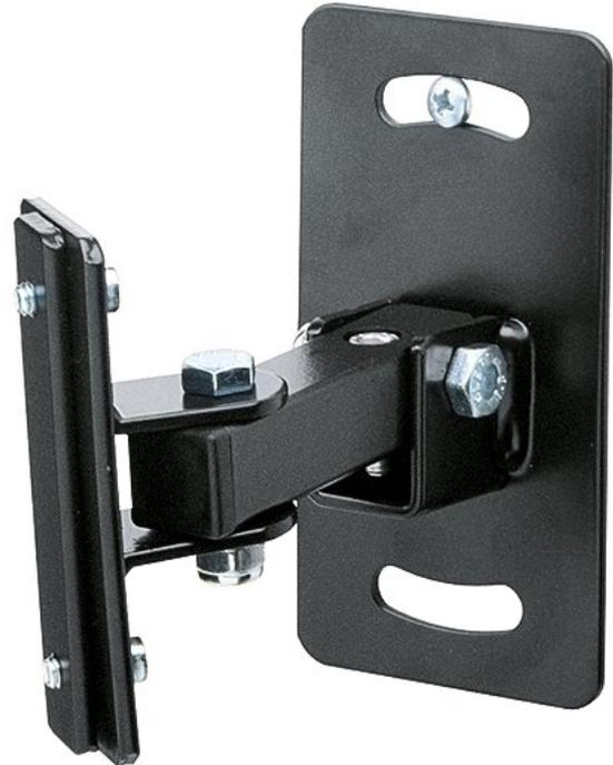
Zur Befestigung von Boxen durch schmale (20 x 98 mm) oder breite Klemmlasche (24 x 98 mm). Wandabstand 105 mm, seitlich schwenkbar mit Neigung bis 15°.
