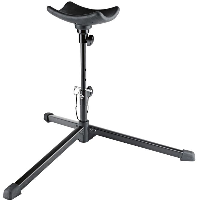
Extrem niedriges und leichtes Modell für alle Tuben. Der Einrast-Sockel hat drei Profilfüße, die für den Transport umgeklappt werden können. Die höhenverstellbare Rohrkombination kann zusätzlich mit einem Splint in drei Positionen abgesichert werden. Eine gummigepolsterte Instrumentenauflegeschele schützt die Tuba beim Einsatz und kann für den Transport auch abgenommen werden.
