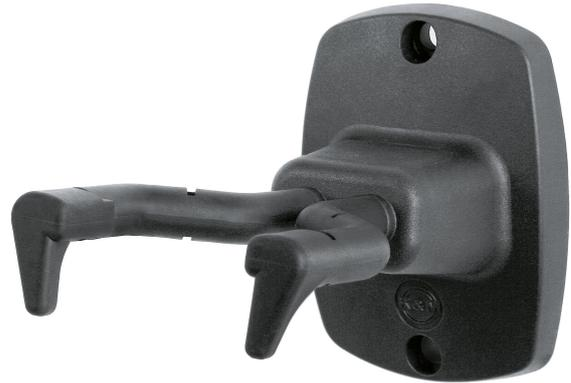
Anschraubbare Wandhalterung mit patentiertem, beweglichem Einhängesystem, dessen Bügel bei Belastung den Gitarrenhals einklemmen und sich bei Entlastung selbst öffnen. Besonders geeignet für asymmetrische Formen. Zapfen an den Bügelenden sorgen für zusätzliche Sicherheit. Mit instrumentenschonendem Gummipolster.
