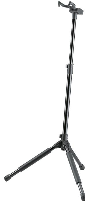
Zusammenlegbarer Ständer für Gitarren aller Art. Mit patentiertem, beweglichem Einhängesystem, dessen Bügel bei Belastung den Gitarrenhals einklemmen und sich bei Entlastung selbst öffnen. Besonders geeignet für asymmetrische Formen. Zapfen an den Bügelenden sorgen für zusätzliche Sicherheit. Höhenverstellbar mittels formschöner Klemmhebel. Verdrehssicheres Auszugsrohr und spezielles Gummipolster zum Schutz der Gitarrenoberfläche. Stabile Fußkonstruktion mit verstärktem Sockel.
