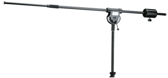
Ausziehbare Rohrkombination, mit 1/2" Anschlussgewinde und verstellbarem Ausgleichsgewicht. Sichere Klemmung durch handlichen Knebel. Stativanschlussgewinde 1/2". Zur Komplettierung von Grundmodell 20811 und 21411.
