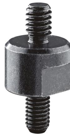
Zur Erweiterung der Tischklammer 23720 für zusätzliche Anwendungen. Der Gewindebolzen wird durch ein M6 Gewinde an der Tischklammer befestigt. Das 1/4" Fotogewinde ermöglicht das Anbringen einer Kamera, eines Handheldrecorders oder ähnlicher Geräte.
