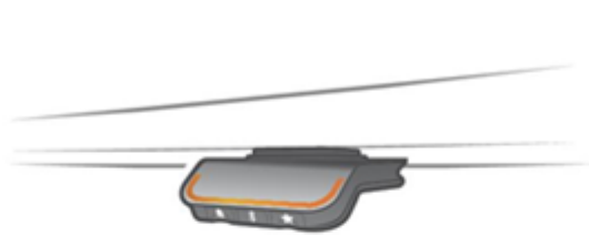
図 4：緑にパルス点滅するライトバーであれば全て正常です。
