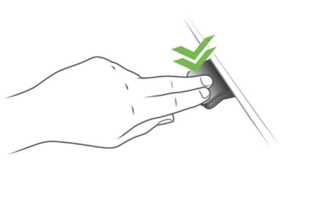
Рисунок 3: Двойное нажатие для автоматического перемещения клавишной стойки в сохраненное положение.
