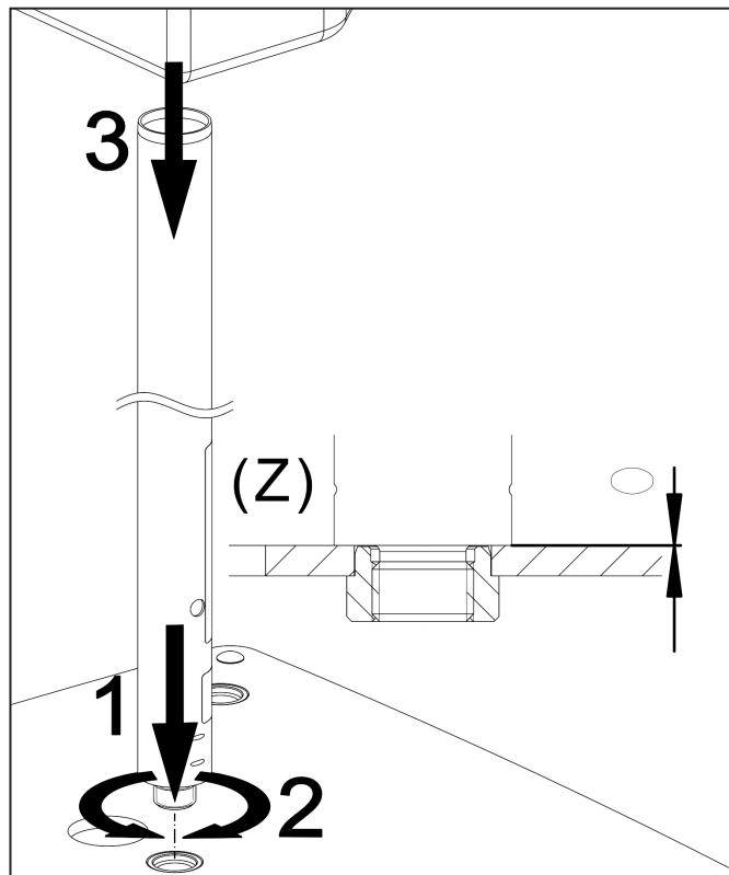
2.) Distanzrohr montieren.
