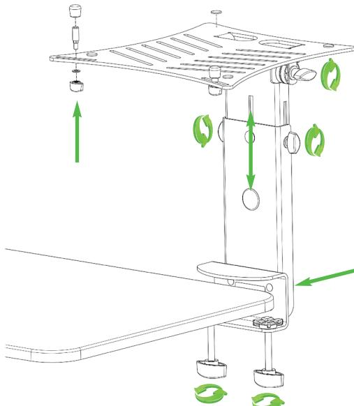
Klemmschrauben an Tischklemmer so weit öffnen, dass die Tischklemmer über die Tischplatte geschoben werden kann. Darauf achten, dass die Tischklemmer komplett an der Tischkante anliegt. Die Klemmschrauben handfest anziehen.
