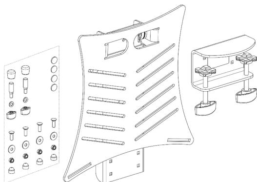
Zubehörbeutel: 2x Schutzkappe, 2x Anschlagbolzen, 2x U-Scheibe ø10 mm, 4x Klemmmutter
