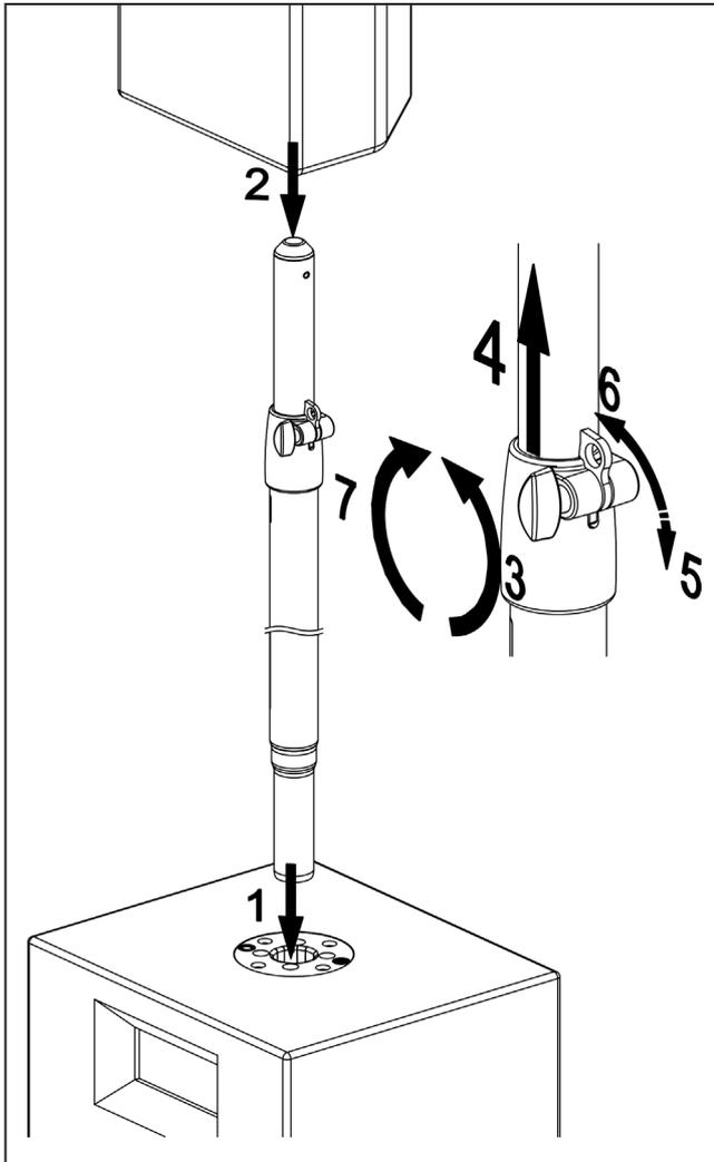
2.) Distanzrohr auf Basis montieren.
