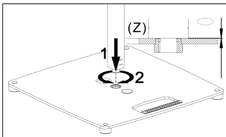
Das zu montierende Distanzrohr auf der Sockelplatte aufsetzen 1 und komplett in diese einschrauben 2.
