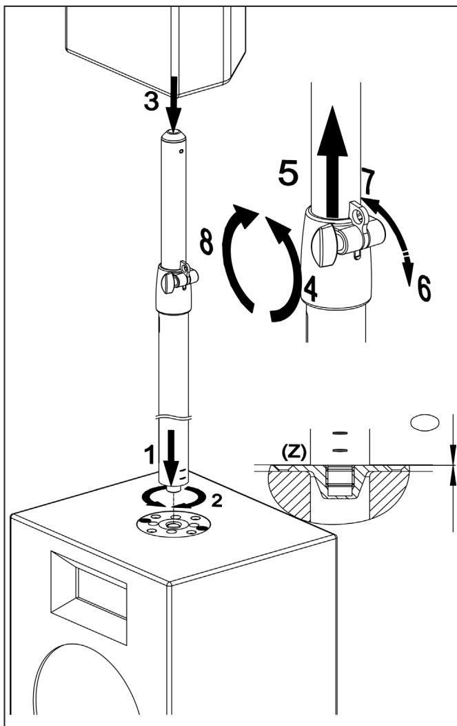
2.) Distanzrohr auf Basis montieren.
