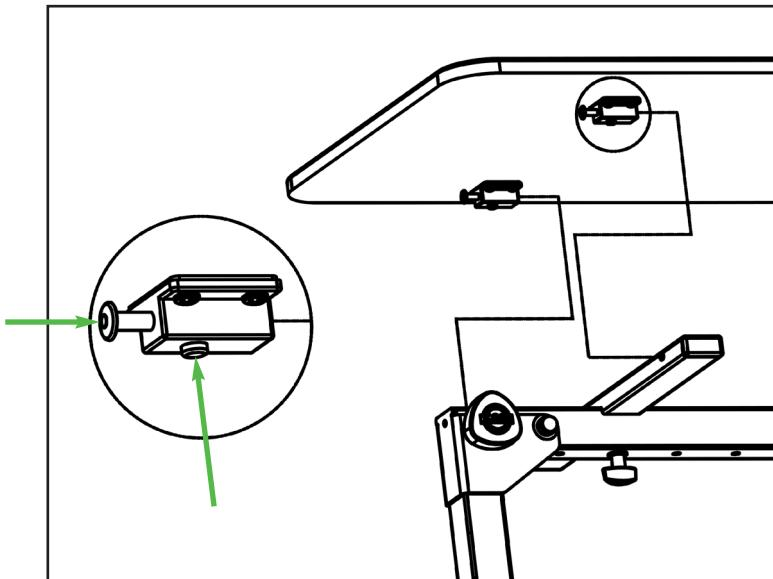
Zum Auflegen der Tischplatte müssen die vier Schnapper „geöffnet“ werden. Hierzu den roten Knopf auf dem Schnapper drücken. Der Verriegelungsstift schnappt nach hinten und die Tischplatte kann montiert werden.
