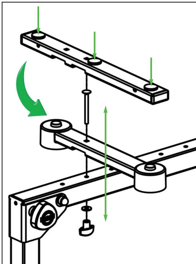
Für die Montage der Tischplatte müssen die Auflagerohre des »Omega« gegen die Auf-lagerohre der Tischplatte getauscht werden. Hierzu die Klemmmutter lösen und mitsamt der Unterlegscheibe entfernen. Das Auf-lagerohr nach oben vom »Omega« abnehmen. Die Auflagerohre der Tischplatte in umgekehrter Reihenfolge montieren. Hierbei darauf achten, dass von außen eine Bohrung frei bleibt und die lange Seite der Auflagerohre auf die lange Seite der Fußrohre zeigt, siehe Hinweis.
