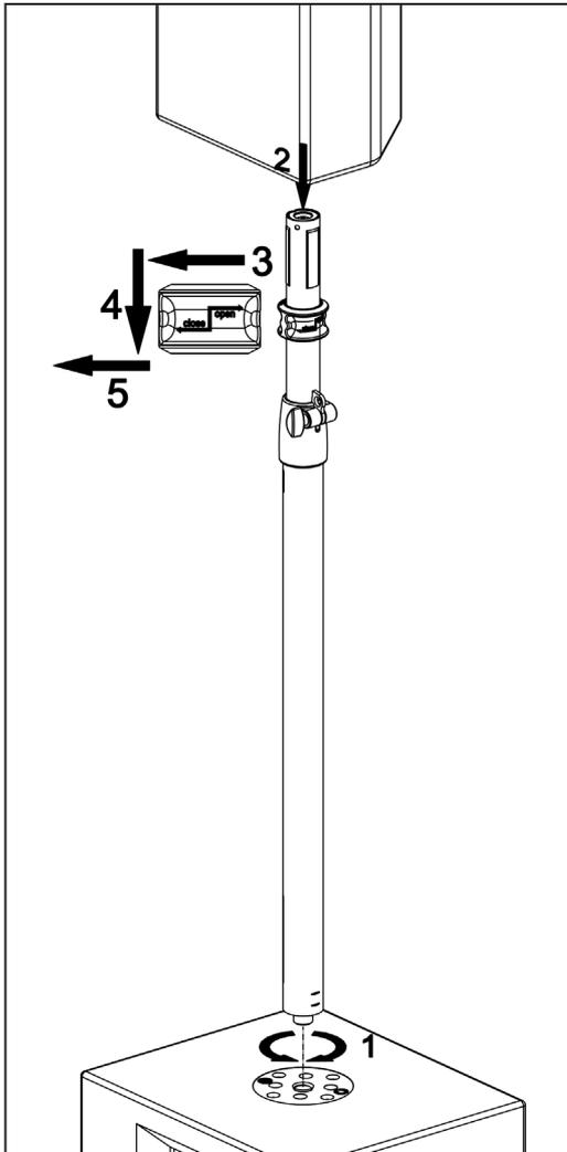
2.) Distanzrohr auf Basis montieren.
