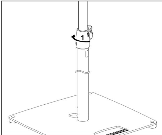
6.) Ausrichten der Rohrkombination
